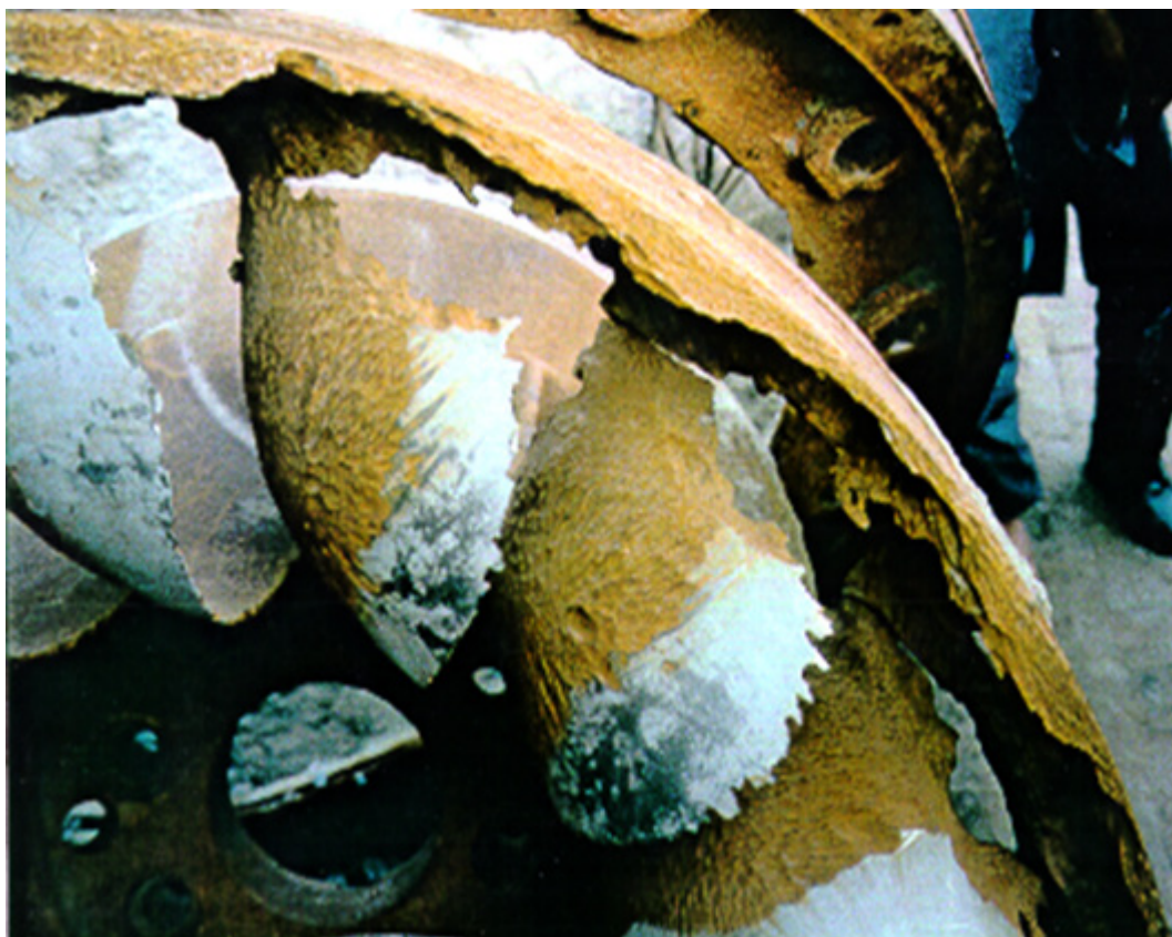
Figure 16 – Dommages sévères dus à l'érosion par particules dans une roue Francis
