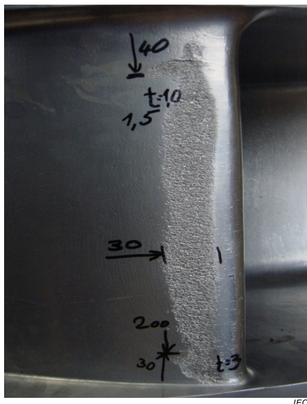
Figure 15 – Érosion par cavitation sur le bord d'attaque d'une aube de pompe-turbine Francis causée par une exploitation à très faible charge pendant de longues périodes
